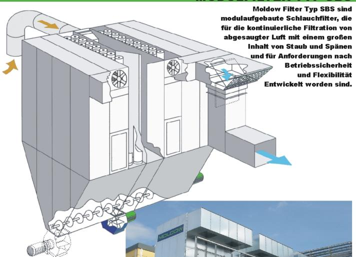
Die SBS Filter sind geschlossene modulaufgebaute Schlauchfilter, die außen verwendet werden und an der Seite des Gebäudes, auf dem Dach oder direkt über dem Abfallsilo/-Container aufgebaut werden. Die Filter sind oben mit einer Neigung von der Mitte gegen die Seiten ausgeführt, damit das Regenwasser abläuft. Die Filter sind mit 16, 32 oder 48 Schläuchen pro Sektion erhältlich.
